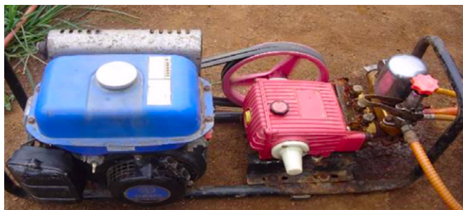
Figura 9. Bomba estacionaria para la fertilización foliar. Fuente: foto de R. Saavedra y M. A. Quintero.
