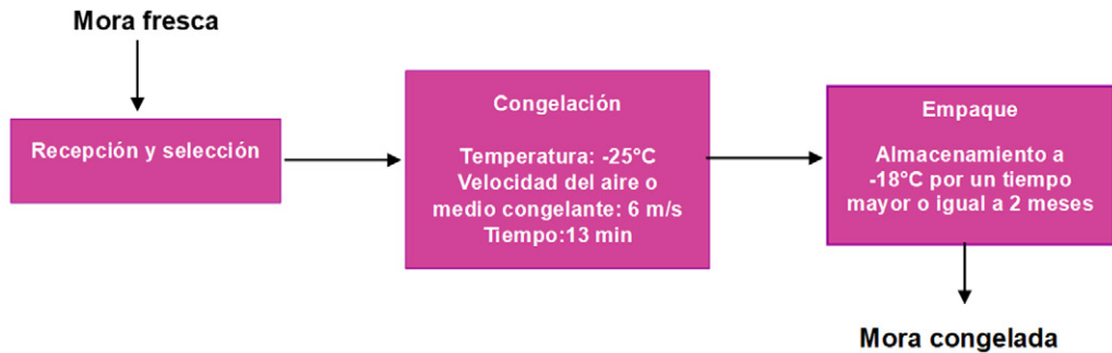
Figura 5. Diagrama de flujo del proceso de congelación 100% de mora de Castilla Fuente: elaboración propia.
